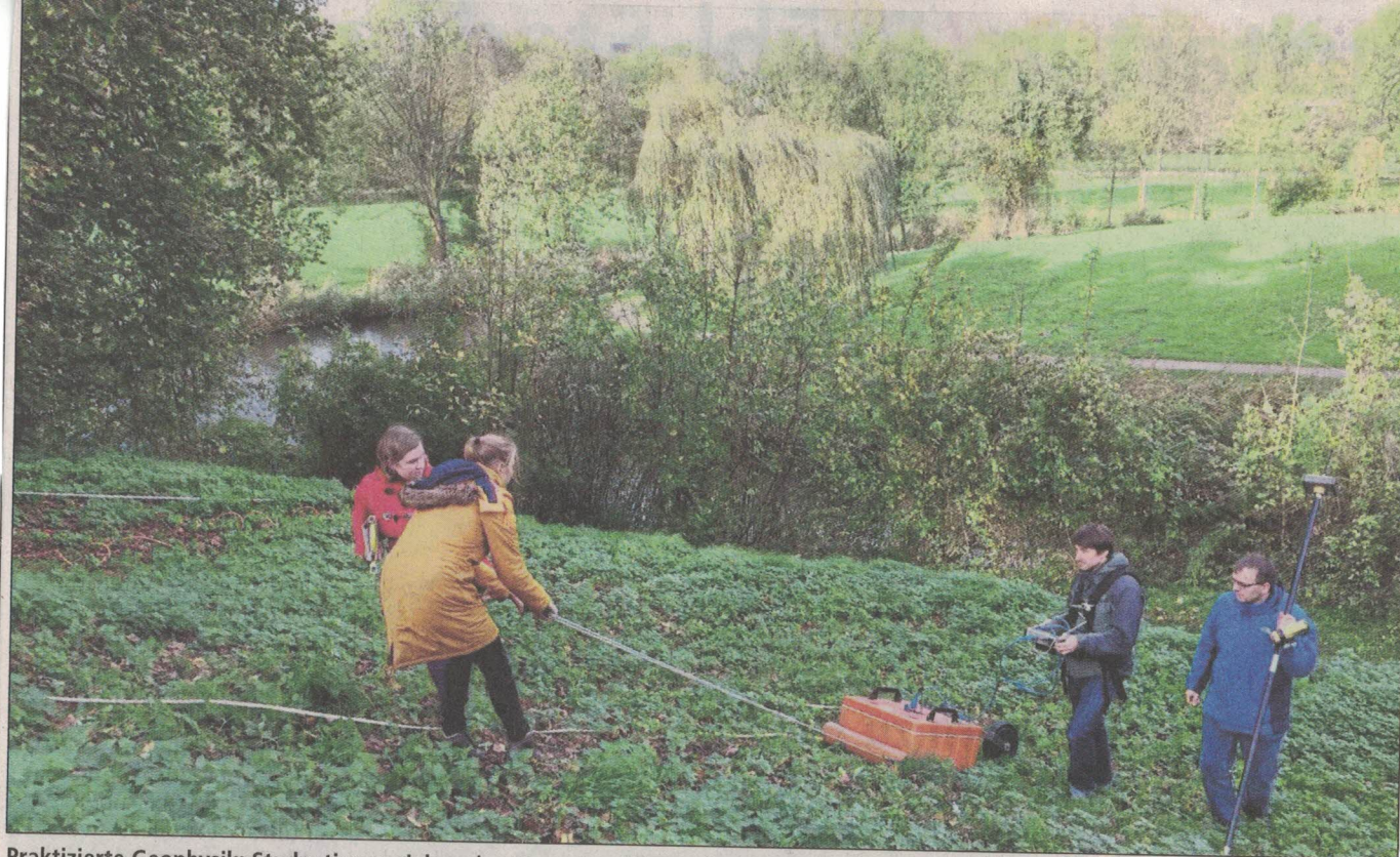
Praktizierte Geophysik: Studentinnen ziehen das Georadar den Burghügel hinauf. Das Bild, welches sie daraus erhalten, gibt Aufschluss über die Zusammensetzung des vor Jahrhunderten aufgeschütteten Hügels und vielleicht auch über verborgene Fundamentreste der einstigen Ringmauer. ■ Fotos: Haarmann
